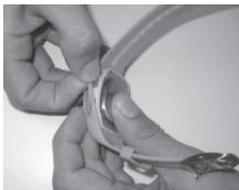
На верхней и нижней кромке корпуса находится четыре небольших фиксирующих крючка (1). Ремешок имеет соответствующие прорези (2). Вложите корпус в ремешок. Осторожно проведите дужки (3), которые охватывают боковые кнопки, через кнопки.
